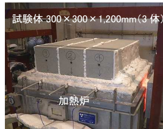
写真-1 加熱試験状況
