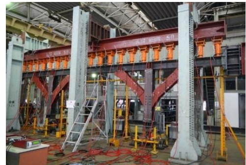
写真-1 45° 火打ち試験体
