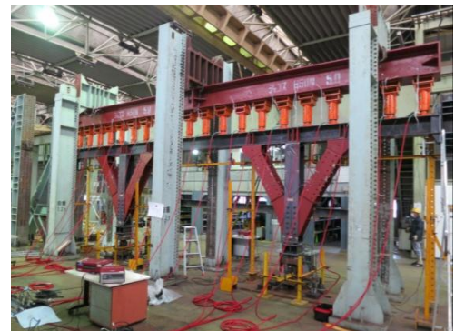
写真-2 60° 火打ち試験体
