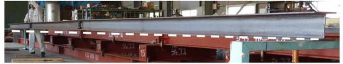
写真-1 補助鋼材 (上向き弓形)
