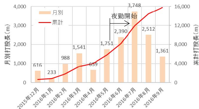
図-6 アンカー工の施工実績
