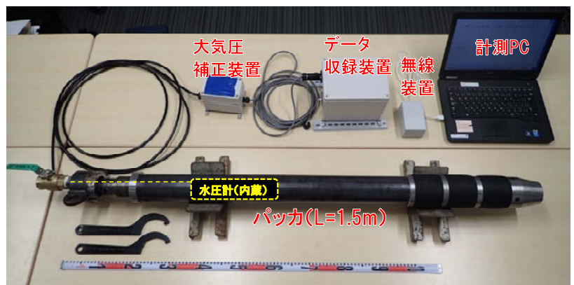
図-2 短尺水圧計測システム (全景)
