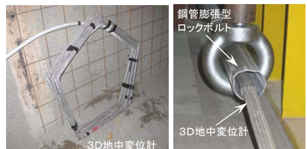
写真－1 簡易型切羽前方変位計の概要
