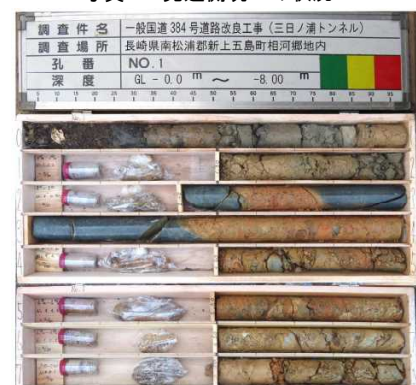
写真2 追加ボーリングのコア
