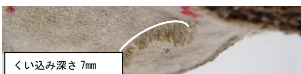
写真4 実験後のベントナイトの食い込み ( b=3.48\text{mm} )
