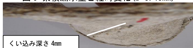
写真2 実験後のベントナイトの食い込み ( b=1.66\text{mm} )
