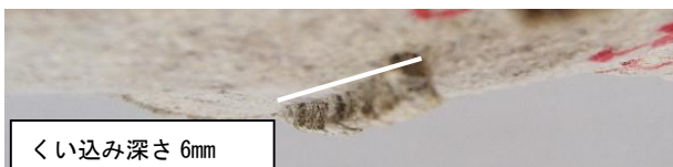
写真3 実験後のベントナイトの食い込み ( b=2.60\text{mm} )
