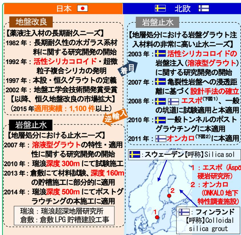
図-3 国内外における溶液型グラウトの研究開発の変遷について<sup>4)</sup>
