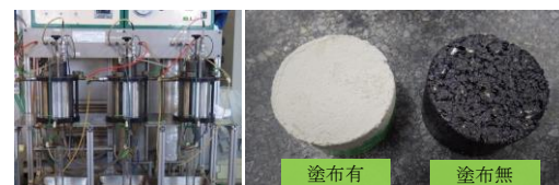
写真-1 加圧式透水試験機と供試体
