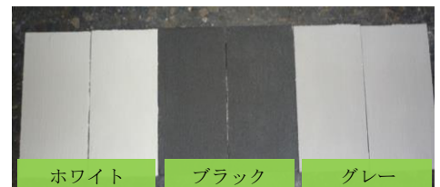
写真-5 耐候性試験前の供試体
