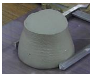
写真-1 フロー試験結果 (練り上がり直後)
