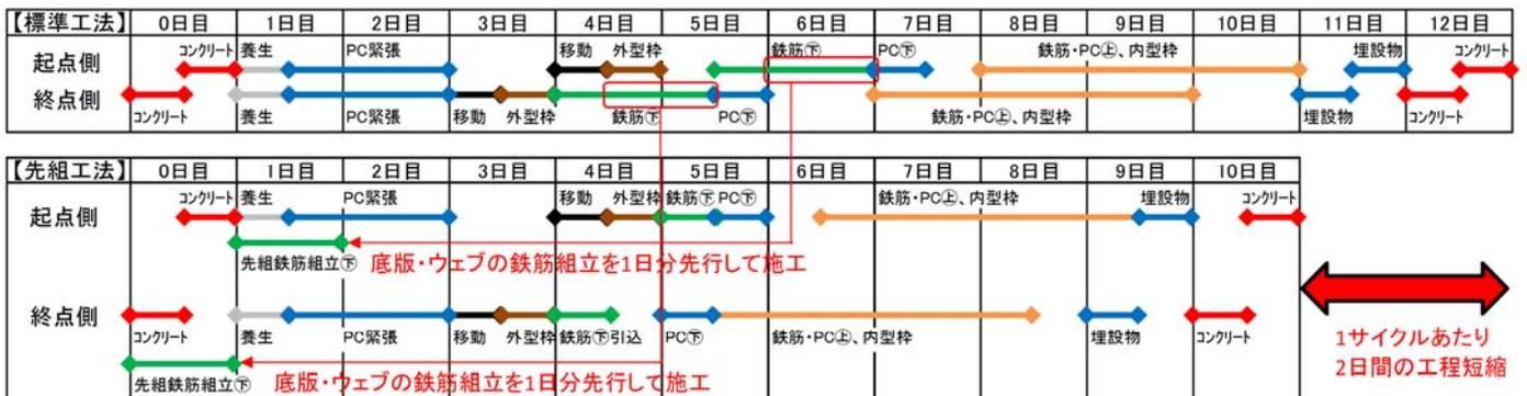
図-4 張出し架設サイクル工程の短縮効果
