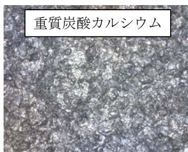
写真1 素地調整完了後の表面状況（マイクロスコープによる撮影）
