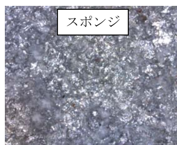
写真1 素地調整完了後の表面状況（マイクロスコープによる撮影）
