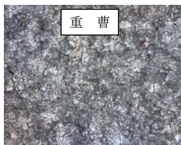
写真1 素地調整完了後の表面状況（マイクロスコープによる撮影）
