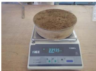
写真—3 吹付け材重量測定
