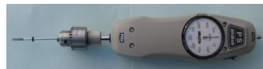
写真-2 ドライバー+荷重測定器
