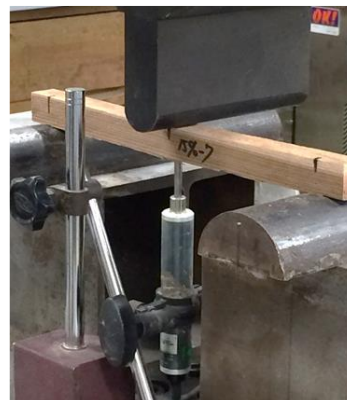
写真-1 曲げ試験状況
