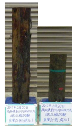
写真-3 縦圧縮試験用供試体
