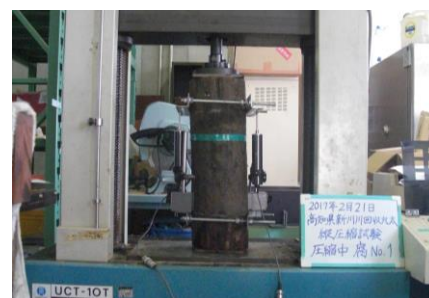
写真-2 縦圧縮試験状況
