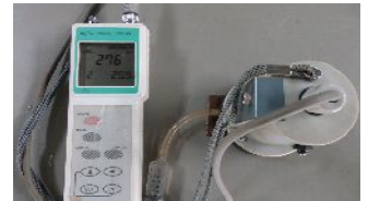
写真-5 付着塩分計測状況
