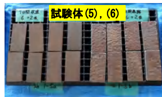
写真-2 腐食鋼板
