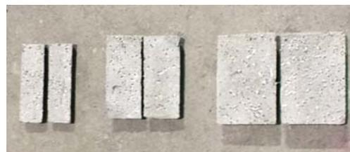
図-2 半分に切断したコアの例
