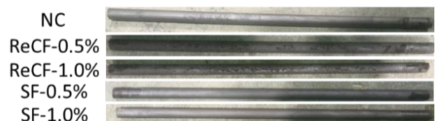
図-4 腐食生成物除去後の鉄筋の様子
