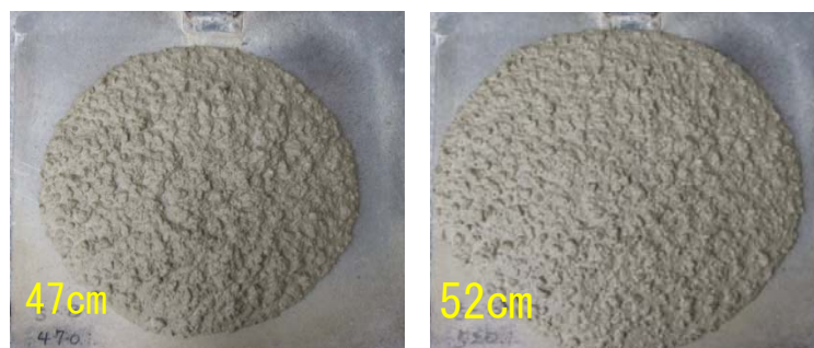
写真-1 分離抵抗性試験状況
