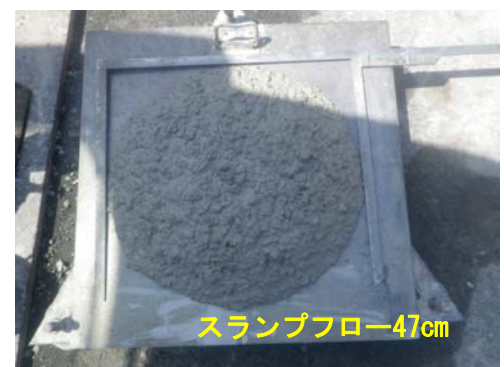
写真-4 施工時の分離抵抗性試験
