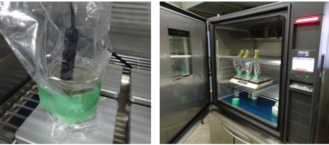
写真-1 電解液による導電率の計測状況
