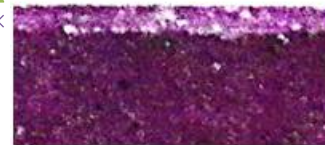
写真1 中性化試験体(BE-S)のフェノールフタレイン呈色状況(表層部拡大)
