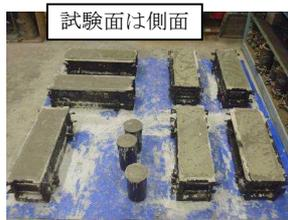
写真-1 試験体作製状況
