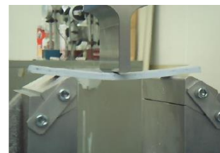
図 3.2 軸方向の強度試験方法
