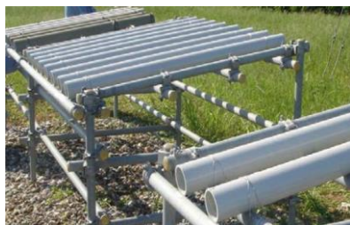
図 2 暴露試験体の設置状況
