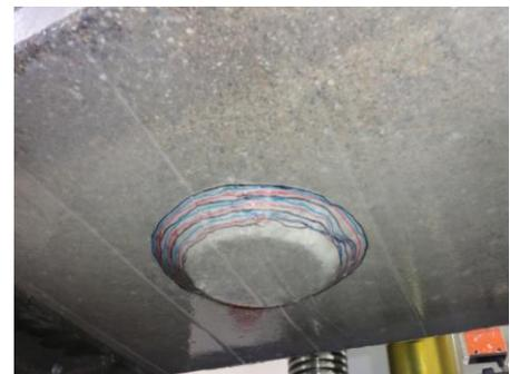
写真-2 押し抜き試験状況
