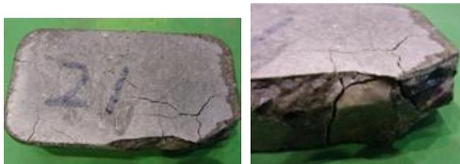
図-1 模擬飛灰溶液へのOPCの浸漬(3年7か月)
