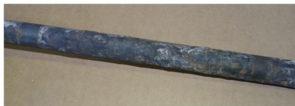
写真-4 ASR 試験体 B1 の PC 鋼棒の腐食状況
