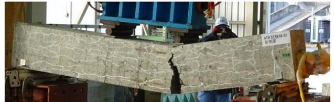
写真-1 ASR 試験体 B1 の破壊状況
