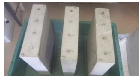
写真-2 供試体の塩水吸い上げ状況
