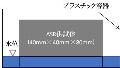
図-2 ASR 供試体における吸水試験の概要
