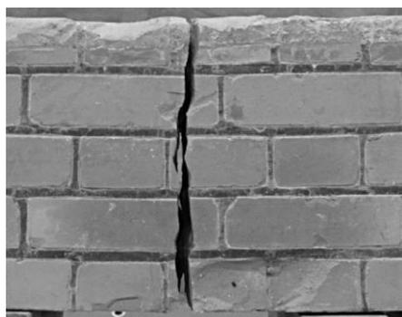
写真-1 曲げ試験後引張縁写真
