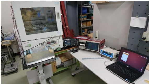
図1 超音波計測システム
