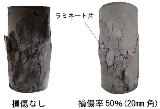
写真-1 供試体の破壊性状
