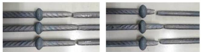
写真 2. MD16 引張試験結果 (SA 径左 30mm, 右 35mm)
