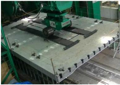
写真-3 輪荷重走行疲労試験状況 (NEXCO 総研所有)
