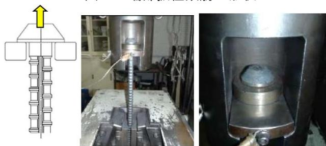
図-2 引張試験状況
