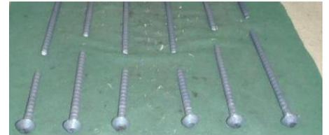
写真-1 引張試験による破断状況
