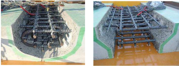
(a) ループ継手 (b) 拡径鉄筋継手
