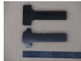
写真-2 ビッカース硬さ試験供試体
