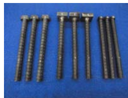
写真-1 くさび引張試験供試体
