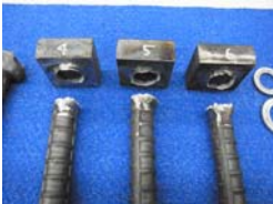
写真－6 溶接試験片破壊状況
