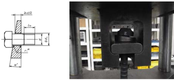
図－1 くさび引張試験状況
