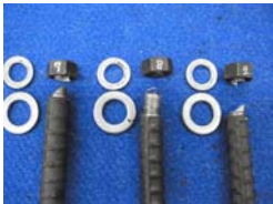
写真－7 ネジ試験片破壊状況
