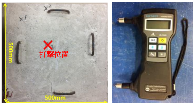
写真1 試験体の外観(上側) 写真2 インパク超音波測定器
