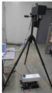
写真 2.1 表面弾性波の計測
