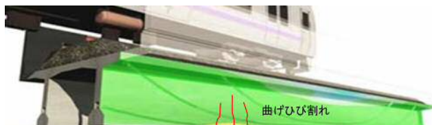
図-1 列車通過時に PC 桁に生じる曲げひび割れ
