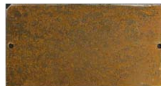
写真-1 4種ケレン後の試験片
