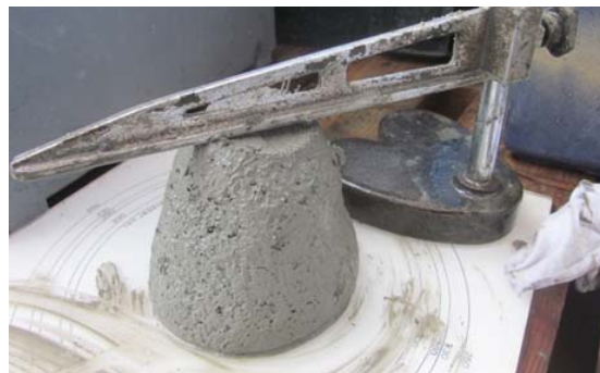
写真-2 スランブ試験の状況
