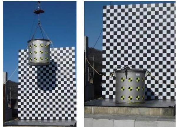
写真1 落下試験状況 (左: 落下前、右: 落下後)
