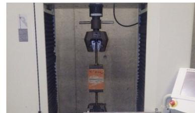
写真1 付着引張試験状況 (100kN 試験機)
