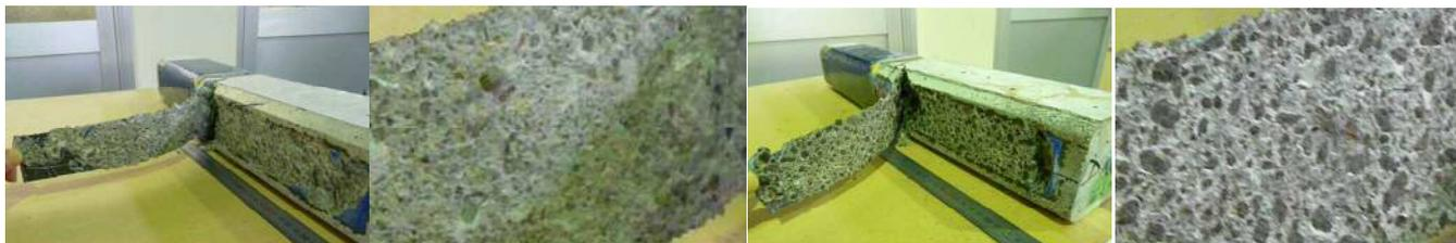
(1) 普通コンクリートの剥離破壊状況 (2) 軽量コンクリートの剥離破壊状況
