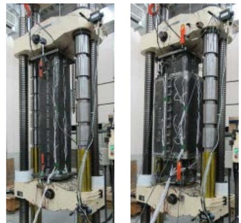
写真-1 1 軸引張試験状況
