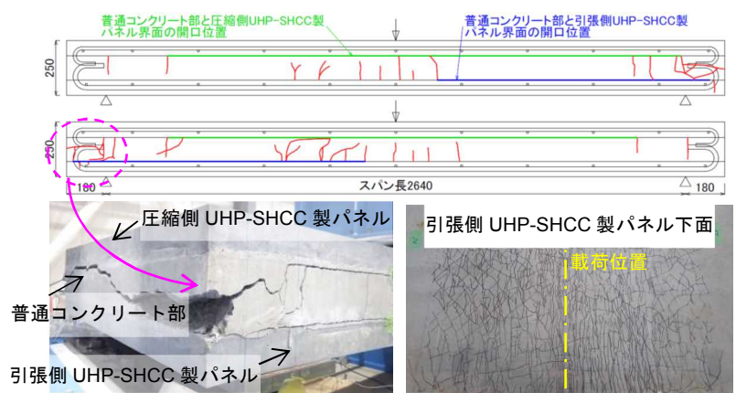
図-3 試験後のひび割れ状況
