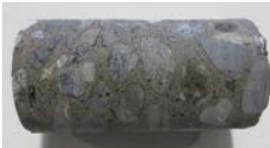
写真-3 大正供試体 No. 2 60 サイクル時の損傷状況
