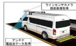
写真-1 車載式レーダー装置 図-1 レーダー探査システム
